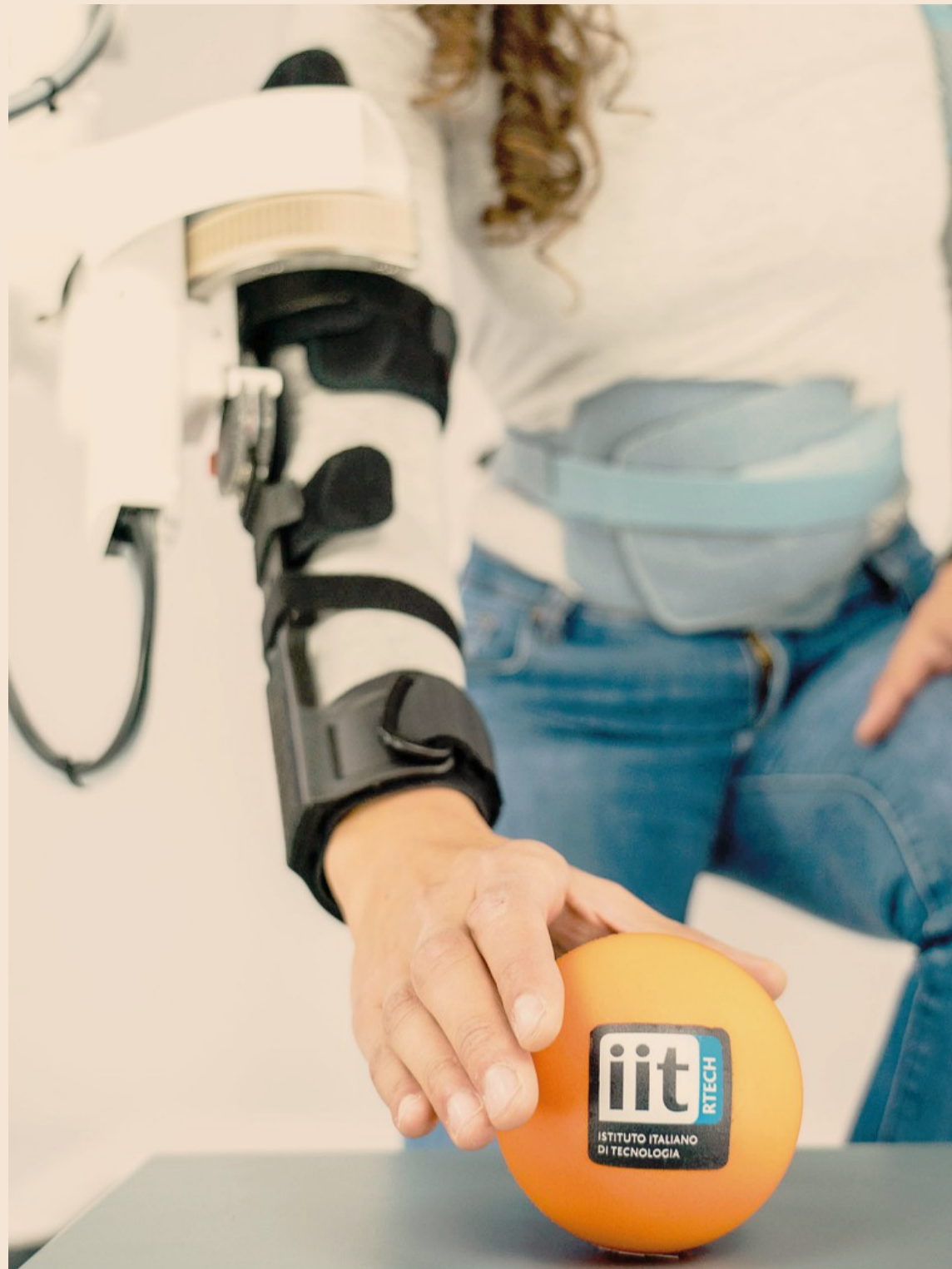
Liberi di riabilitarsi. Il nuovo robot riabilitativo per arti superiori Float permette al resto del corpo totale libertà di movimento
